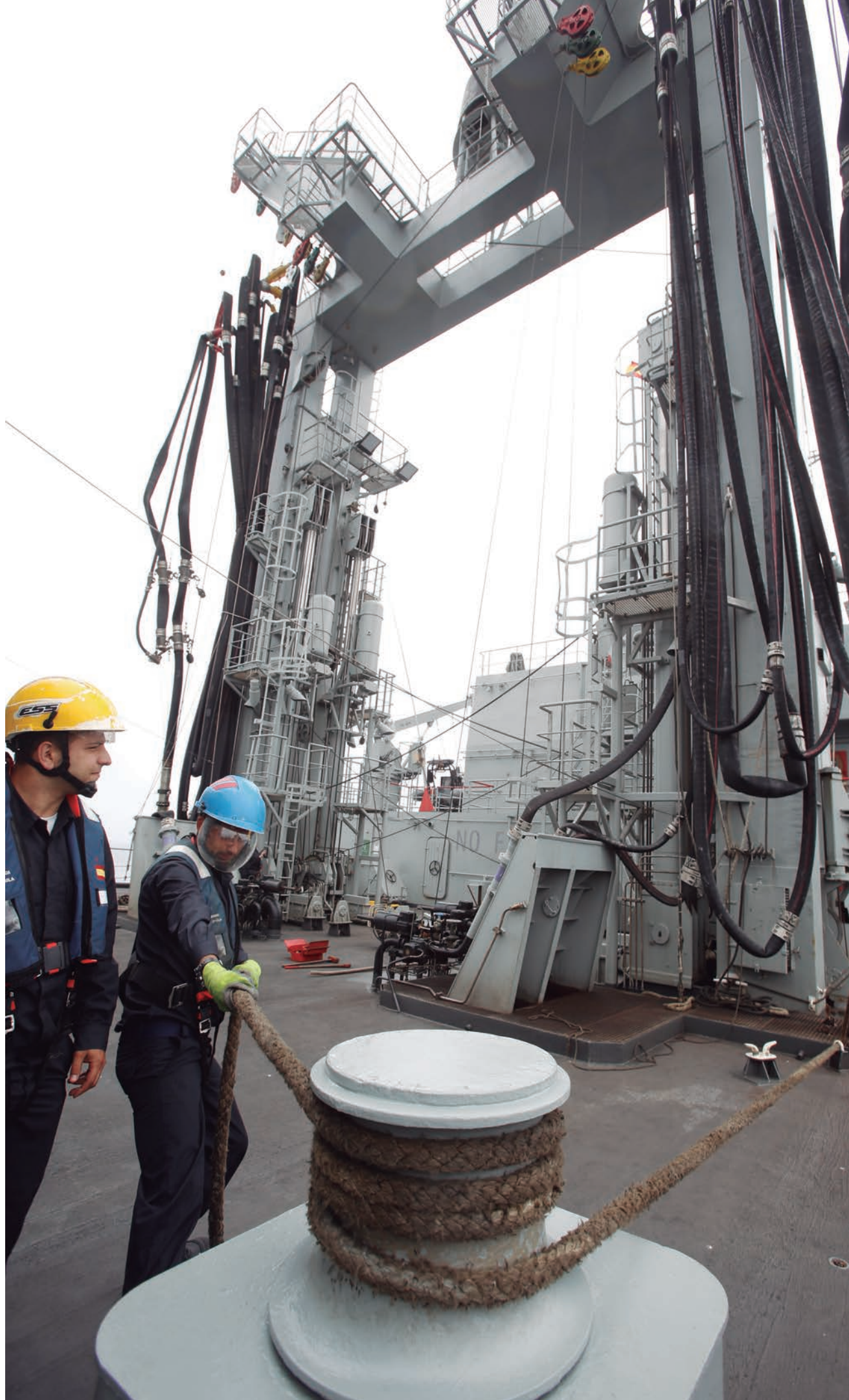
El Patíño en su base de Ferrol (izqda.). El buque dispone de dos pórticos, uno situado a proa (dcha.) y otro a popa, de los que cuelgan las mangueras de combustible. El flujo de transferencia se supervisa desde la Cámara de Control de Plataforma (arriba).
